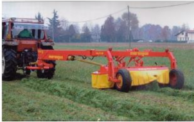
الشكل رقم ٦/٤ . احد أنواع المحشّات الدوّرانية أثناء عملها في الحقل
