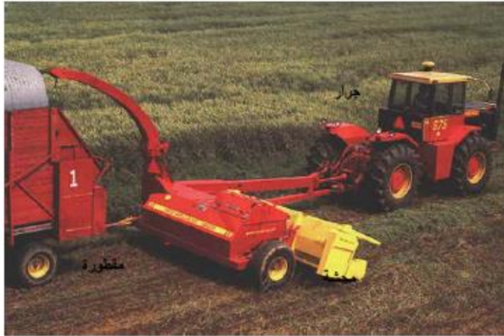
الشكل رقم ٦/١٢ . شبك المحشة الدورانية الطاردة خلف الجرار وبالجانب
