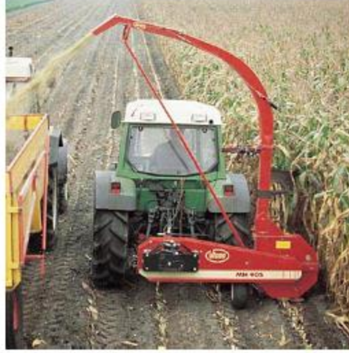
الشكل رقم ٦/١١ . المحشة الدورانية أثناء قيامها بعملية الحصاد
